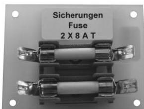
All'interno del bagno d'acqua, nelle immediate vicinanze dell'avvitatura del cavo di alimentazione, si trovano su di un portafusibili i fusibili di rete F1 ed F2 (vedere capitolo 13). Per la loro verifica e sostituzione occorre smontare la lamiera di fondo del bagno d'acqua. I fusibili potranno essere sostituiti solamente con altri con pari caratteristiche. Le informazioni sul tipo di fusibile impiegato sono riportate sulla targhetta accanto ai fusibili e nell'elenco dei ricambi.
