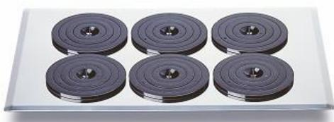
Coperchio forato in "acciaio inox" con 6 anelli multi-parte (4 parti) in plastica resistente al calore, Ø aperture 91 mm, possono essere rimpiccioliti tra 90 e 50 mm a incrementi di 20 mm. Aumenta la versatilità del bagno d'acqua e riduce le perdite di calore provocate dall'inserimento di flaconi alti. Per Hydro H 16, H 16 A e H 22.
