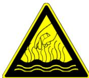
Attenzione! Far raffreddare il bagno d'acqua prima di effettuarvi lavori di riparazione e pulizia! Se necessario, l'acqua contenuta nella vasca può anche essere scaricata dal lato posteriore mediante il rubinetto di scarico.
